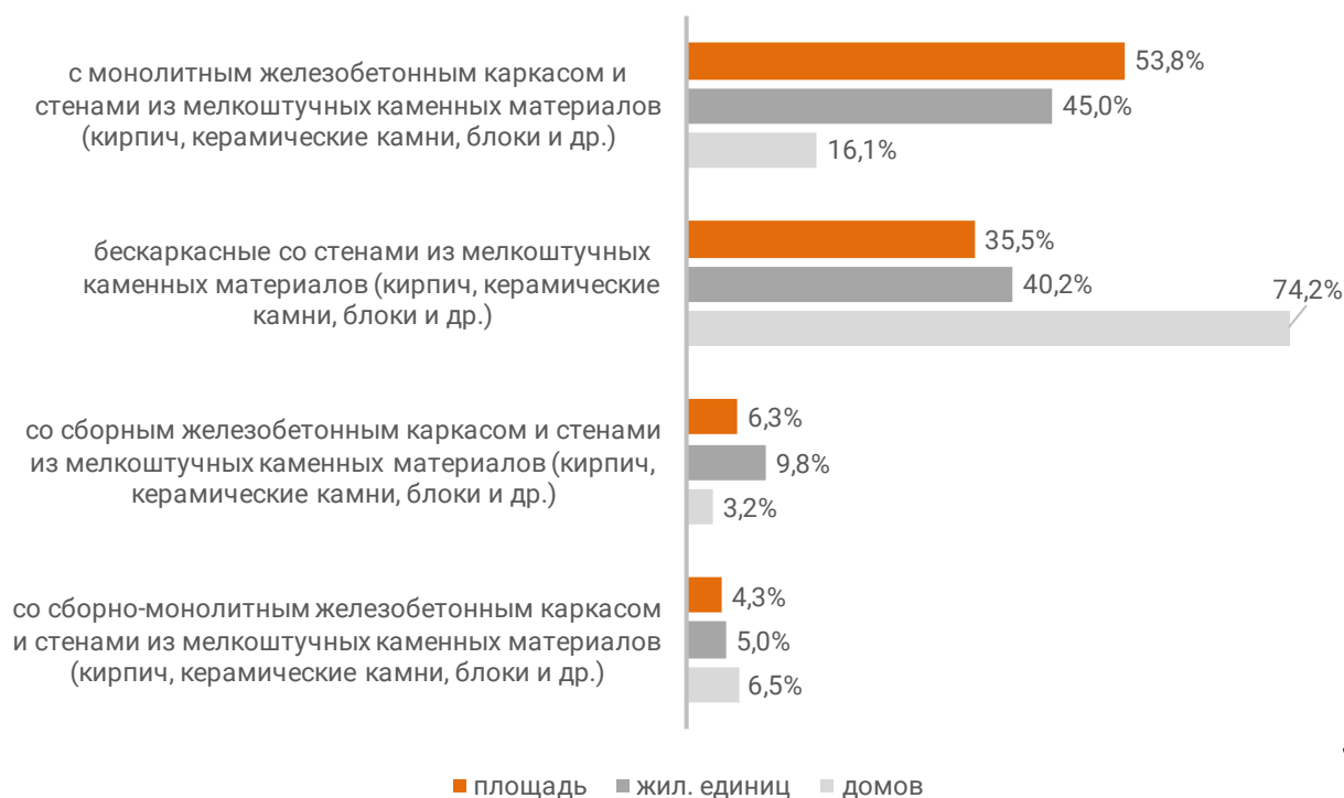
Распределение жилых новостроек Кабардино-Балкарской Республики по материалам стен (по утвержденной форме ПД)
