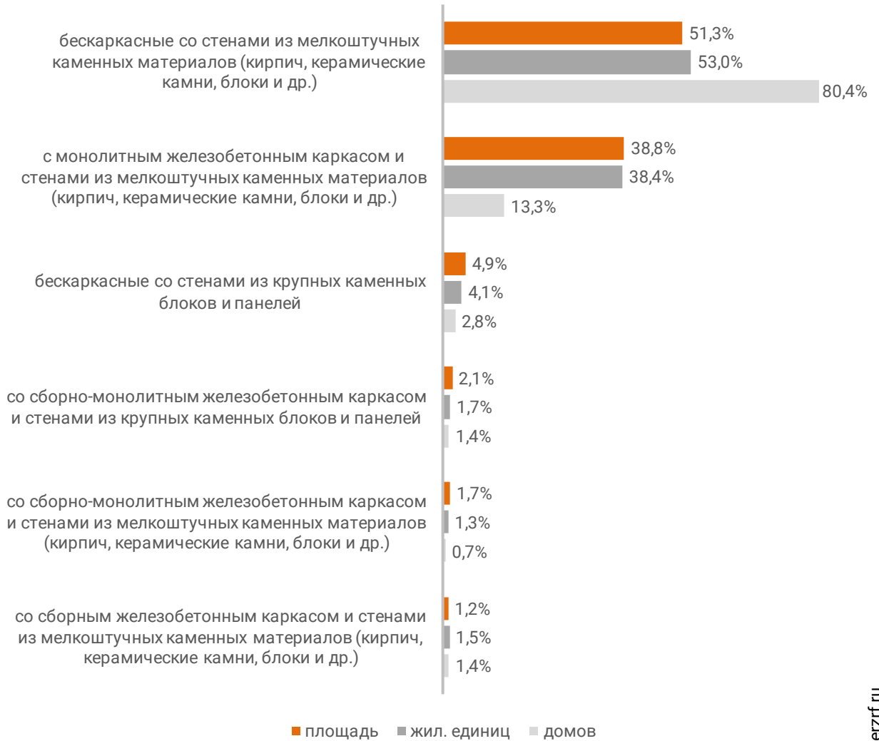
Распределение жилых новостроек Ярославской области по материалам стен (по утвержденной форме ПД)
