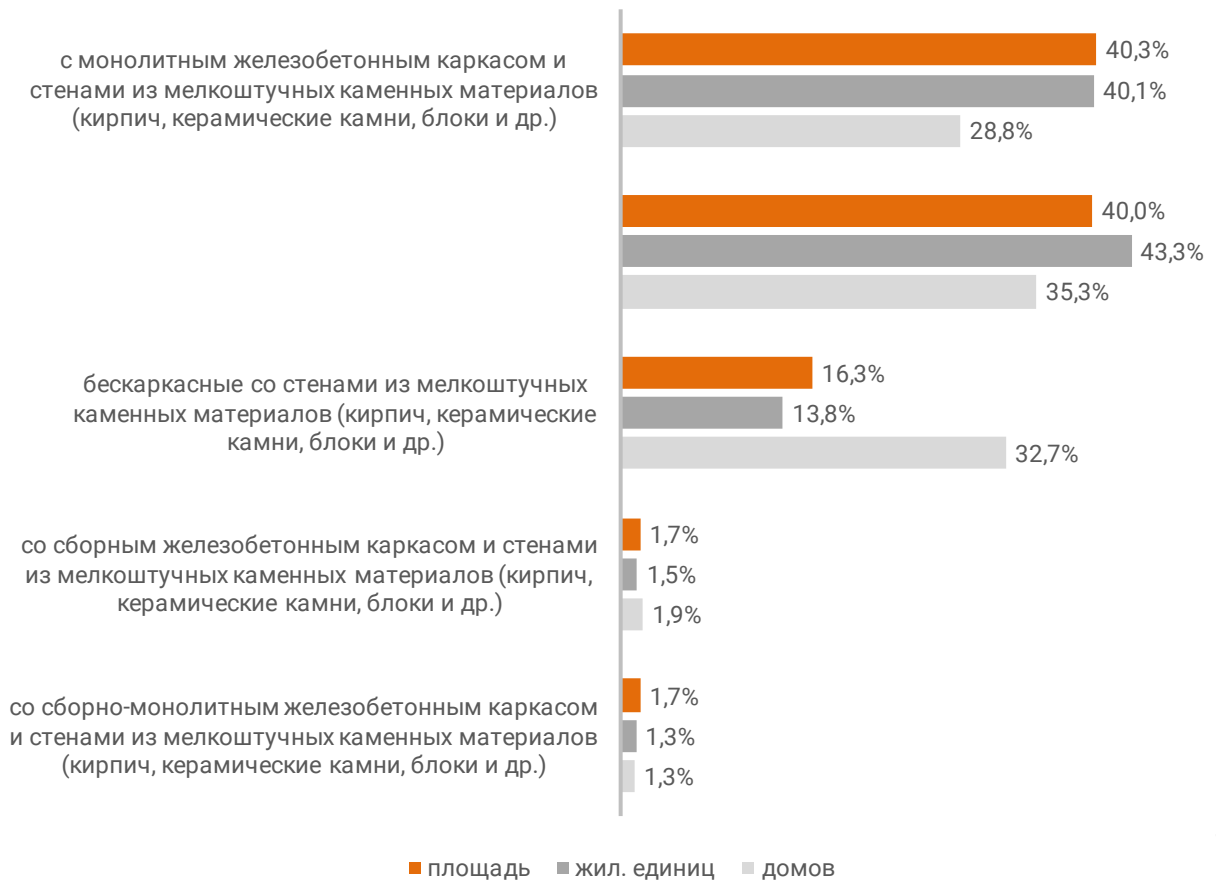
Распределение жилых новостроек Тверской области по материалам стен (по утвержденной форме ПД)
