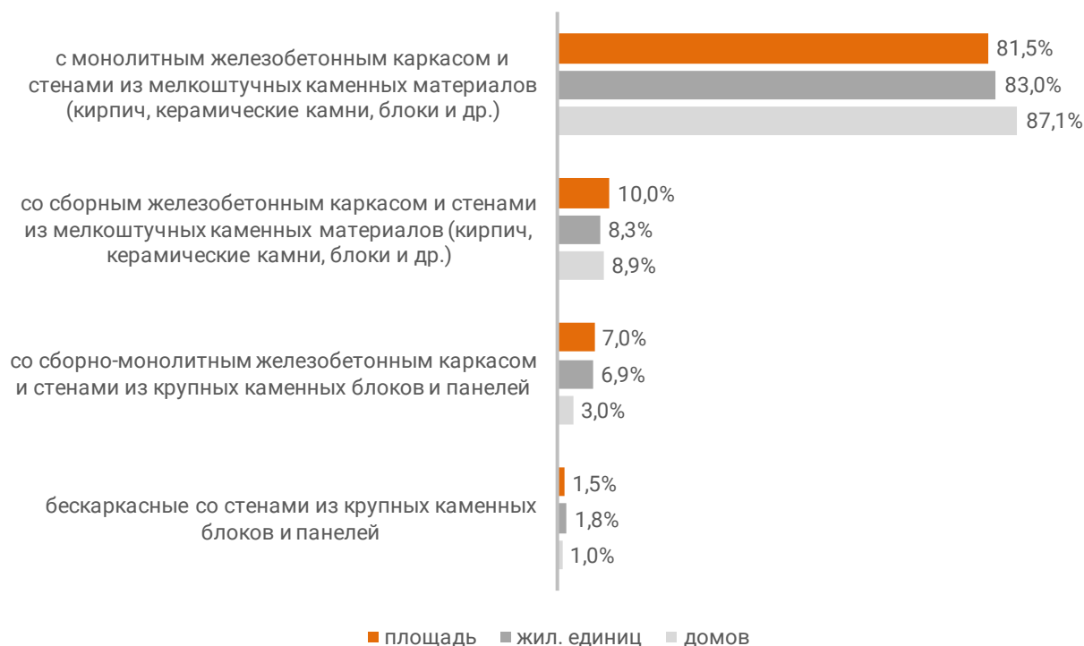
Распределение жилых новостроек Республики Крым по материалам стен (по утвержденной форме ПД)
