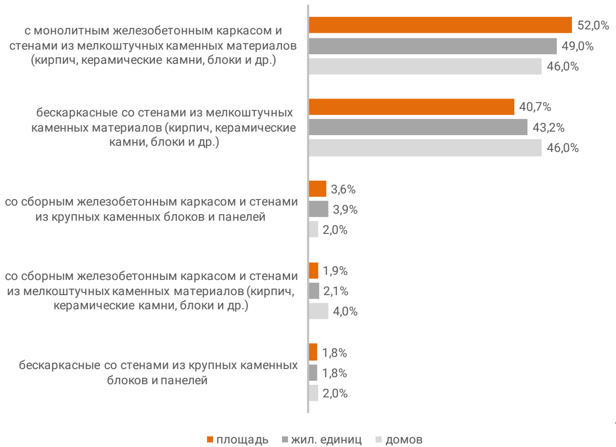
Распределение жилых новостроек Белгородской области по материалам стен (по утвержденной форме ПД)
