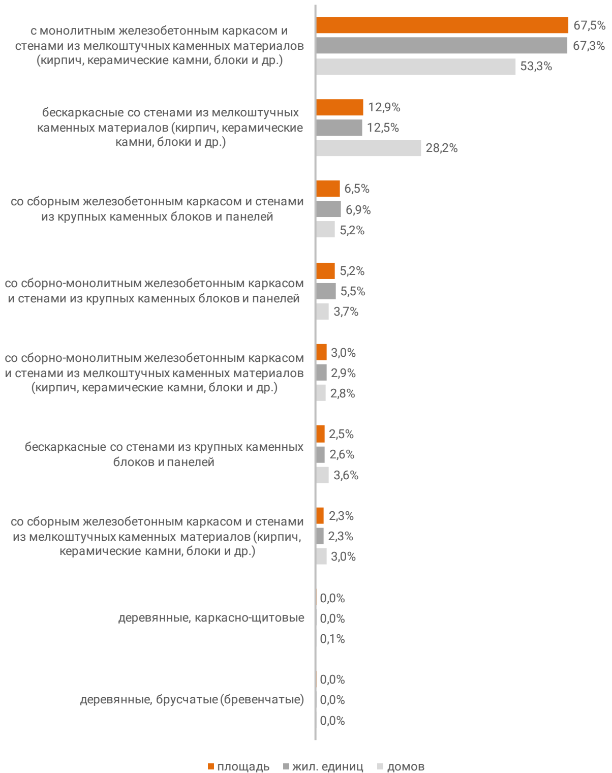
Распределение жилых новостроек Российской Федерации по материалам стен (по утвержденной форме ПД)
