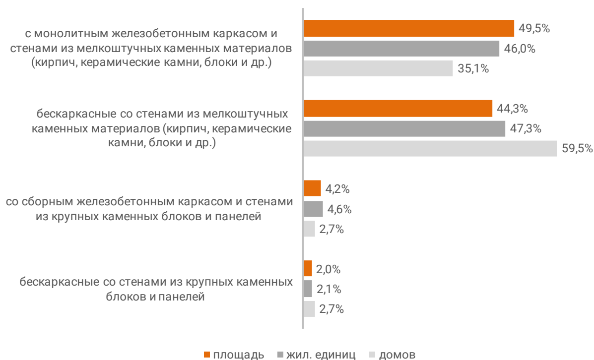
Распределение жилых новостроек Белгородской области по материалам стен (по утвержденной форме ПД)
