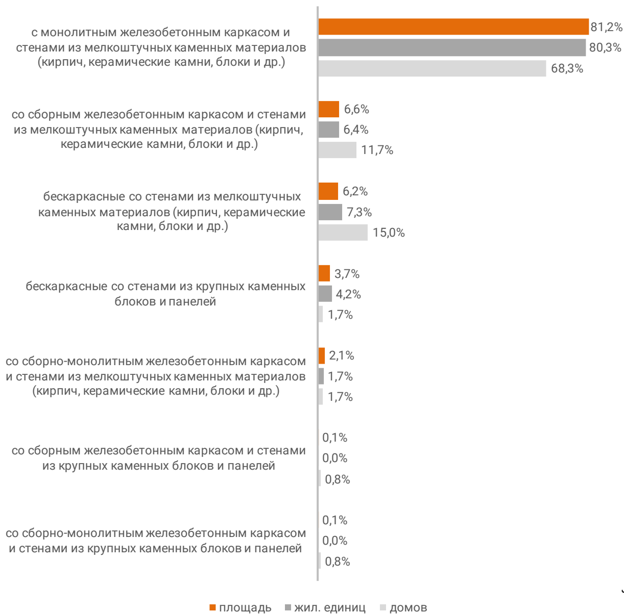
Распределение жилых новостроек Ставропольского края по материалам стен (по утвержденной форме ПД)
