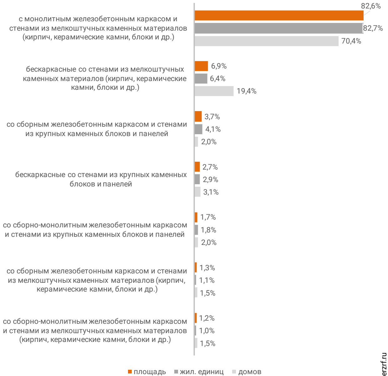
Распределение жилых новостроек Ростовской области по материалам стен (по утвержденной форме ПД)
