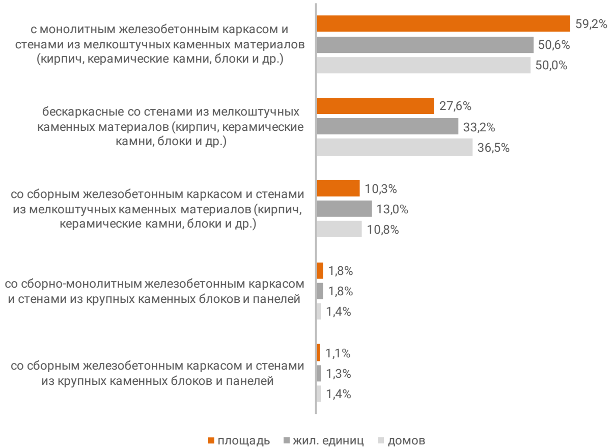
Распределение жилых новостроек Хабаровского края по материалам стен (по утвержденной форме ПД)
