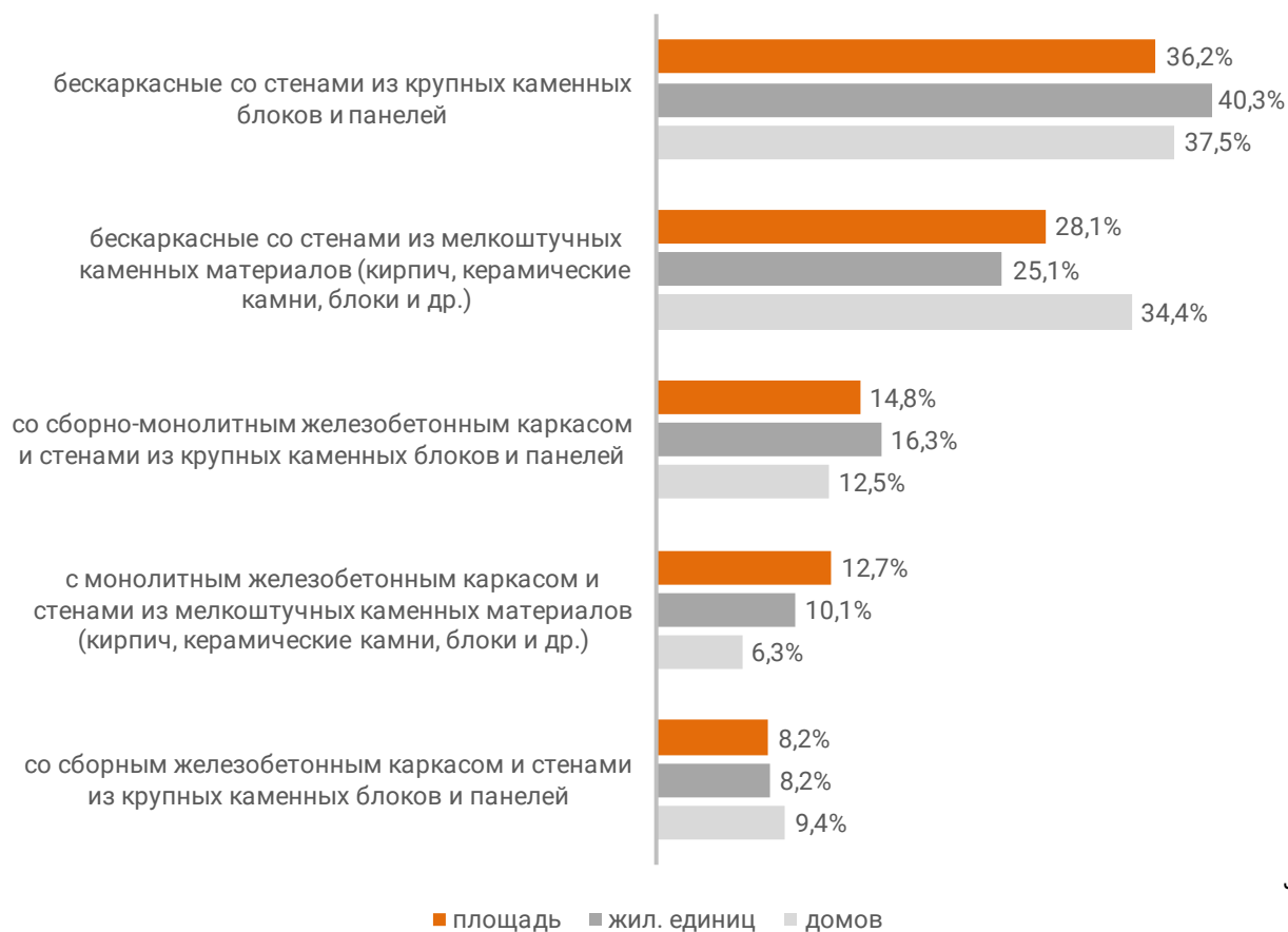
Распределение жилых новостроек Оренбургской области по материалам стен (по утвержденной форме ПД)
