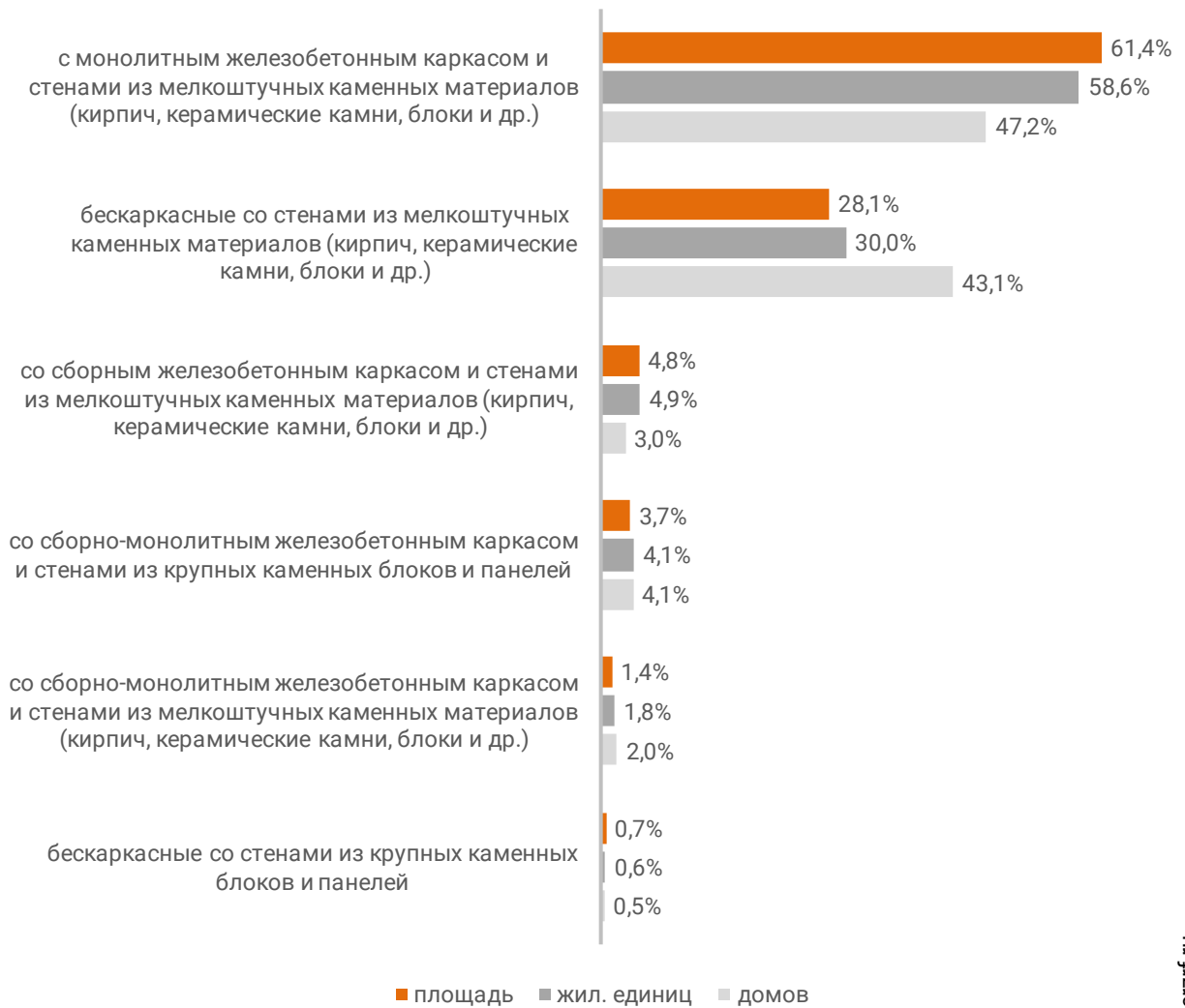
Распределение жилых новостроек Калининградской области по материалам стен (по утвержденной форме ПД)
