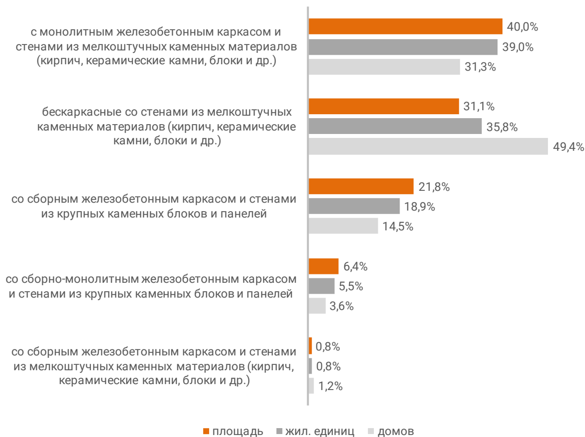
Распределение жилых новостроек Республики Адыгея по материалам стен (по утвержденной форме ПД)
