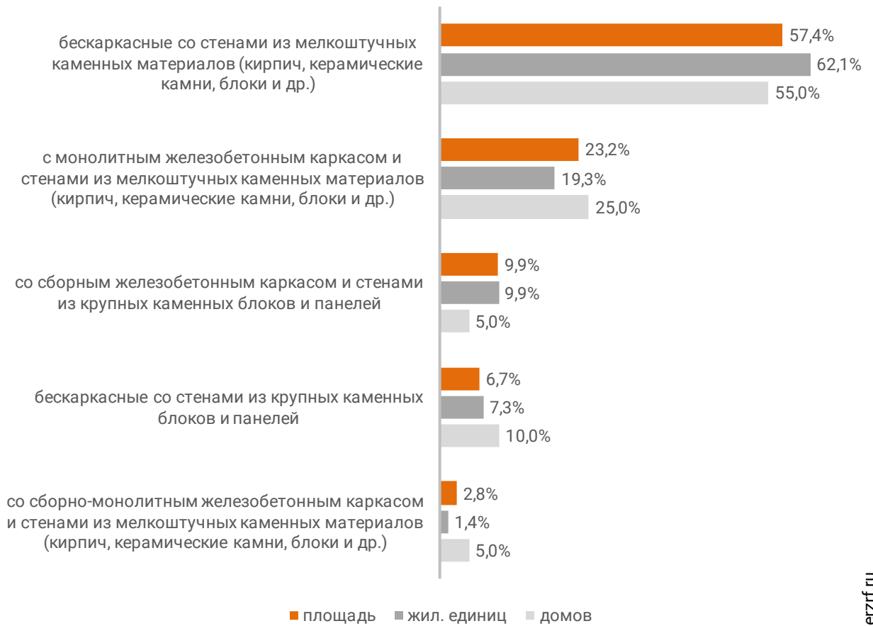
Распределение жилых новостроек Томской области по материалам стен (по утвержденной форме ПД)
