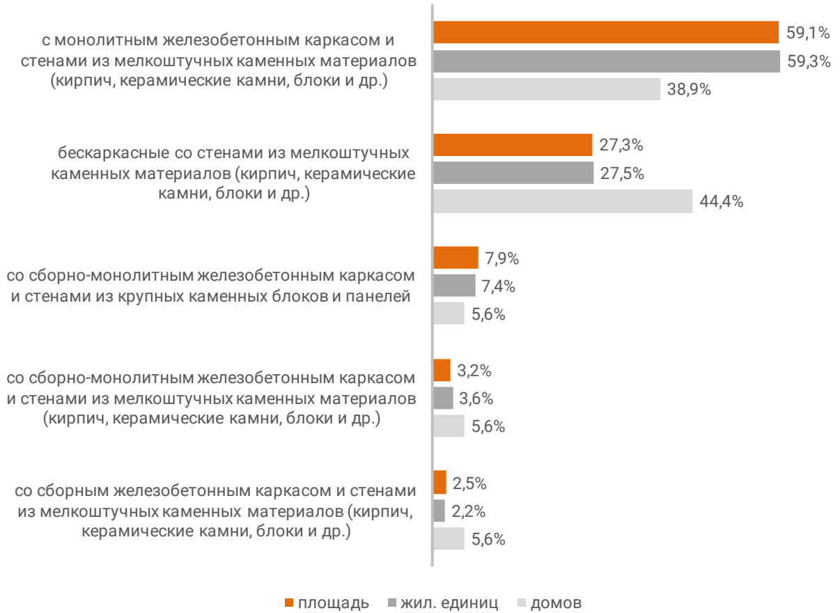
Распределение жилых новостроек Республики Мордовия по материалам стен (по утвержденной форме ПД)
