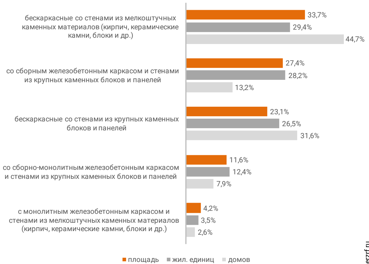
Распределение жилых новостроек Оренбургской области по материалам стен (по утвержденной форме ПД)
