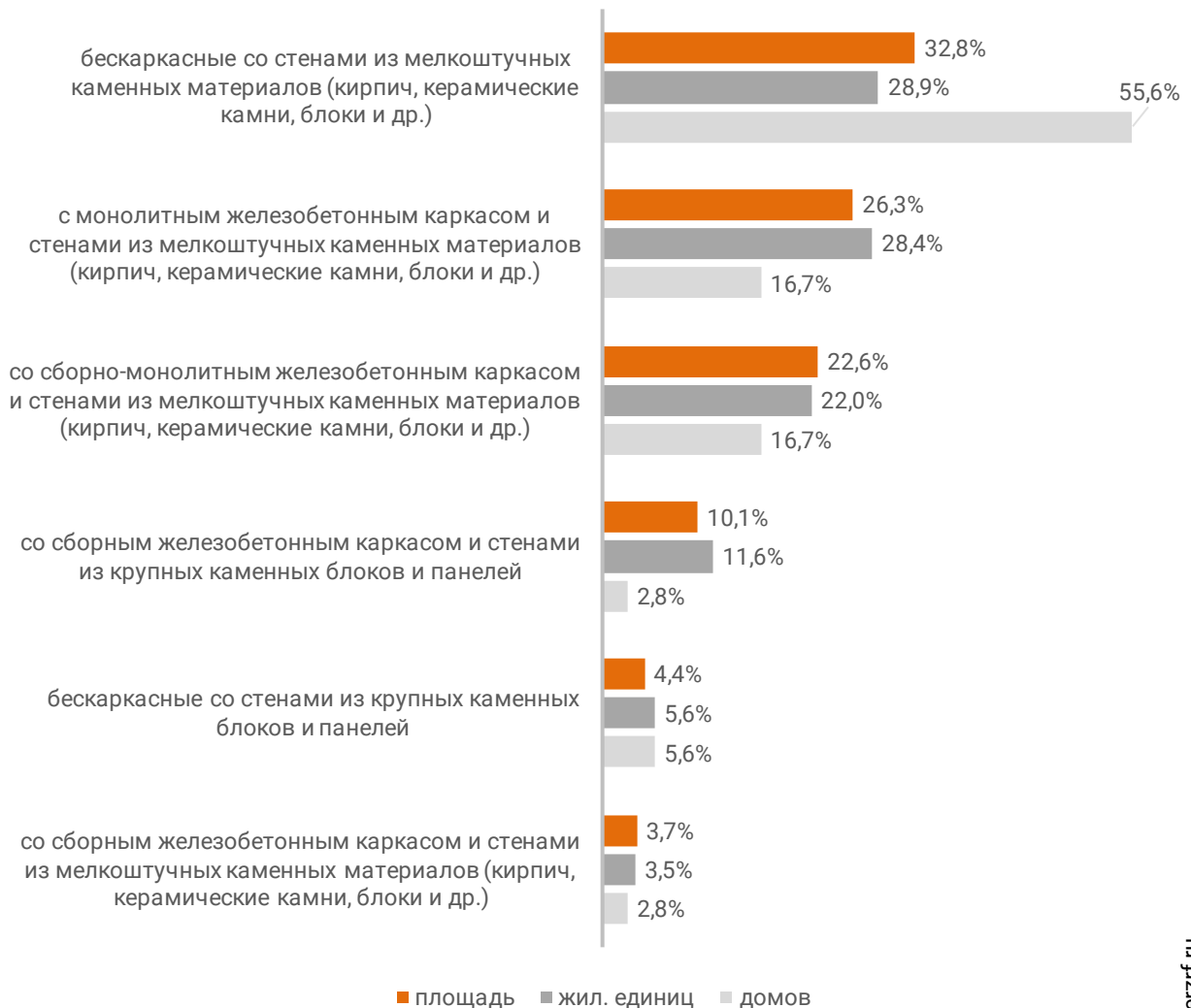
Распределение жилых новостроек Курской области по материалам стен (по утвержденной форме ПД)
