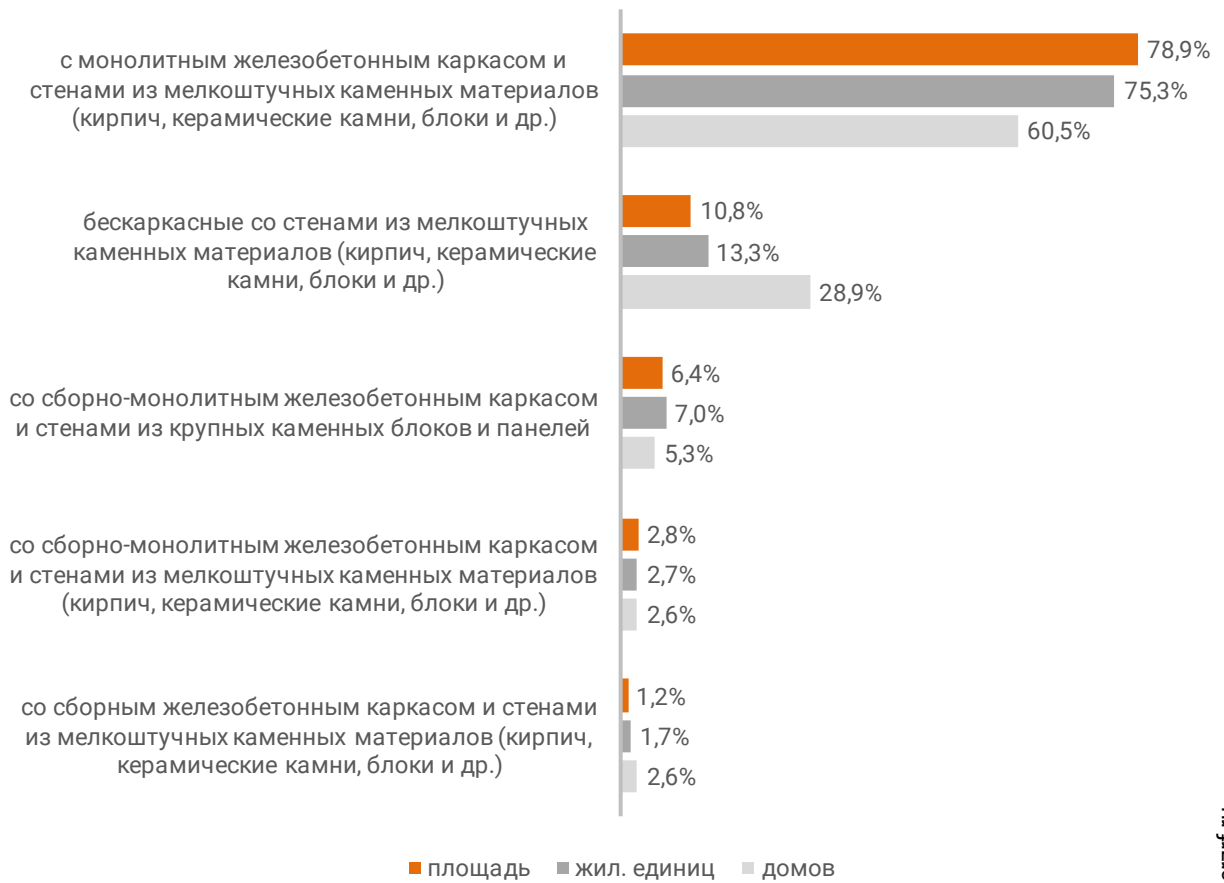
Распределение жилых новостроек Хабаровского края по материалам стен (по утвержденной форме ПД)
