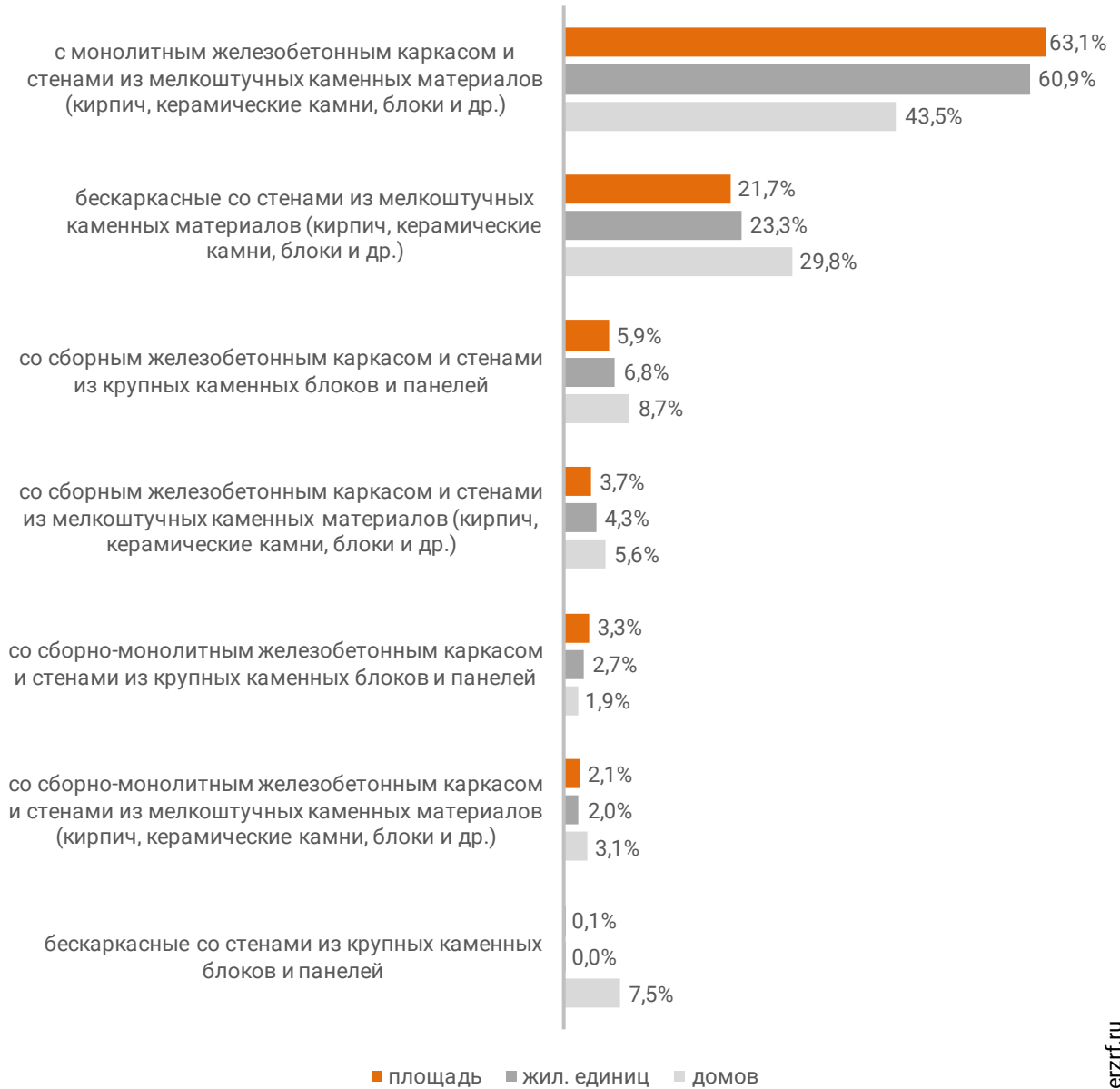
Распределение жилых новостроек Самарской области по материалам стен (по утвержденной форме ПД)
