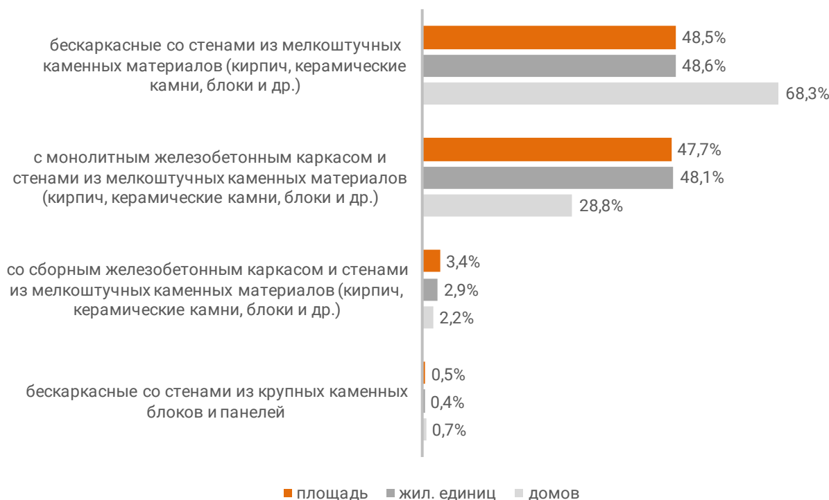
Распределение жилых новостроек Ярославской области по материалам стен (по утвержденной форме ПД)
