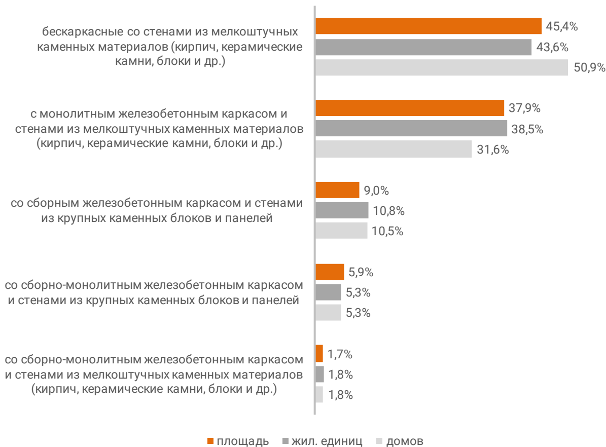
Распределение жилых новостроек Брянской области по материалам стен (по утвержденной форме ПД)
