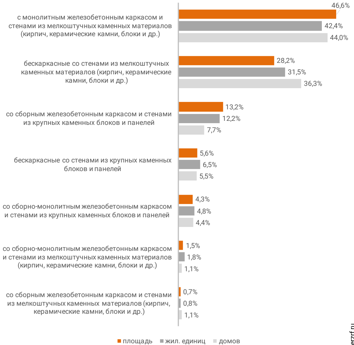
Распределение жилых новостроек Алтайского края по материалам стен (по утвержденной форме ПД)
