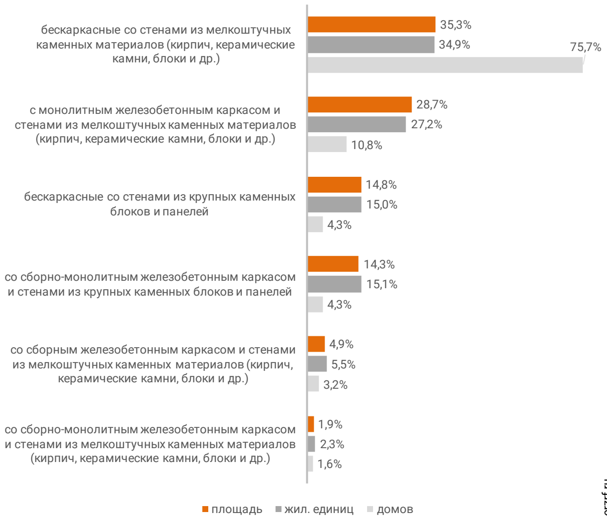
Распределение жилых новостроек Республики Тыва по материалам стен (по утвержденной форме ПД)
