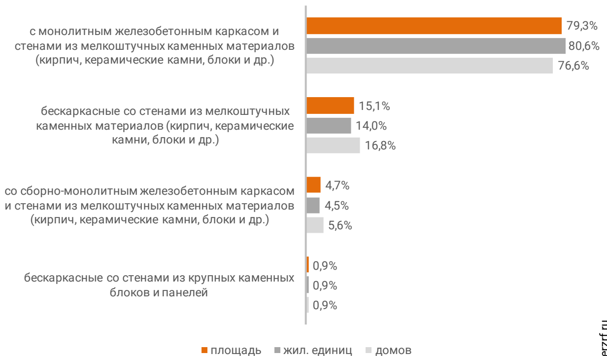
Распределение жилых новостроек Рязанской области по материалам стен (по утвержденной форме ПД)
