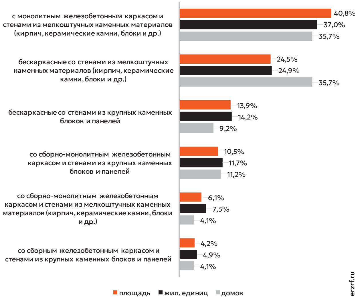
Распределение жилых новостроек Пензенской области по материалам стен (по утвержденной форме ПД)
